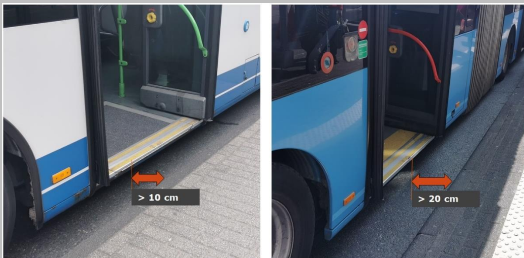
Abbildung 4: Spaltbildung am Einstieg bei nicht optimiertem Ausbau
