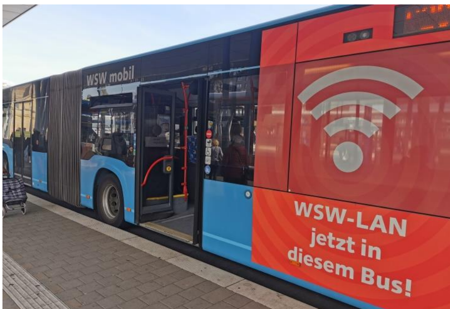
Abbildung 21: Eine Folierung der Scheiben vermindert die Sicht nach außen.
