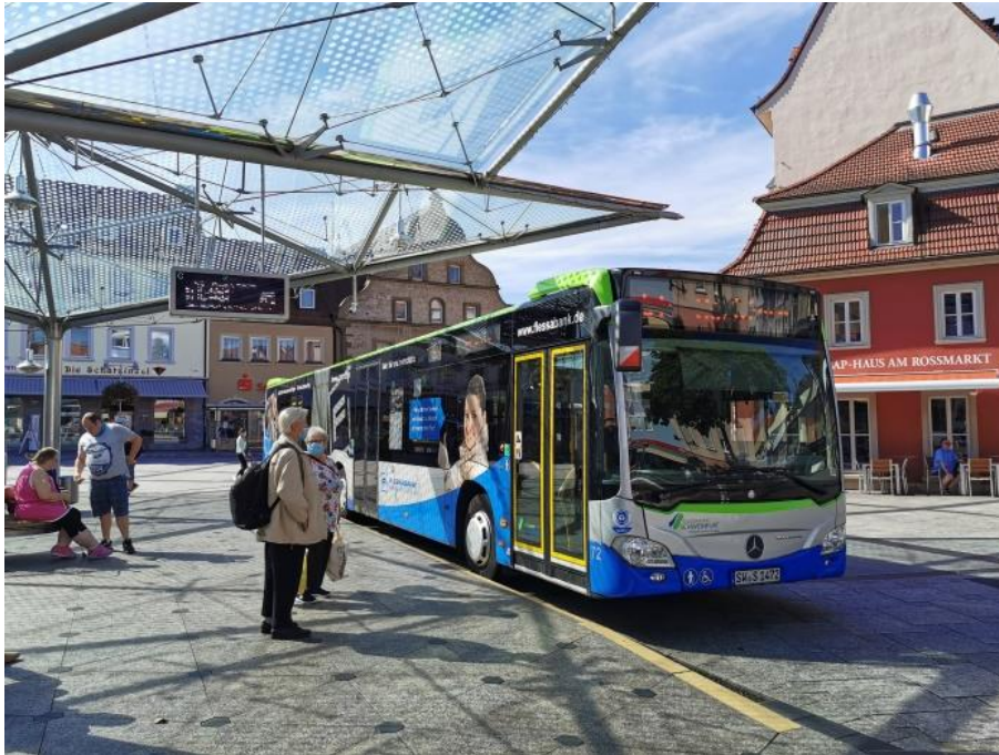
Abbildung 12: Beispiel für Kennzeichnung der Fahrzeugtüren von außen mit kontrastierendem Sichtrahmen an der Tür (Schweinfurt)
