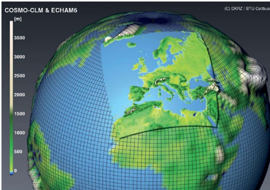
Abbildung 3-2: Beispiel für eine Koppelung eines Globalmodells (hier: ECHAM6) und einem Regionalmodell, hier dem dynamischen regionalen Klimamodell COSMO (CONsortium for Small-scale MOdelling)-CLM bzw. CCLM Modell, das aus dem Wettervorhersagemodell des Deutschen Wetterdienstes entwickelt und durch eine internationale Gemeinschaft von Wissenschaftlern der CLM (Climate Limited-area Modelling)-Community verwendet und weiterentwickelt wird ( http://www.clim-community.eu ). Quelle: DKRZ
